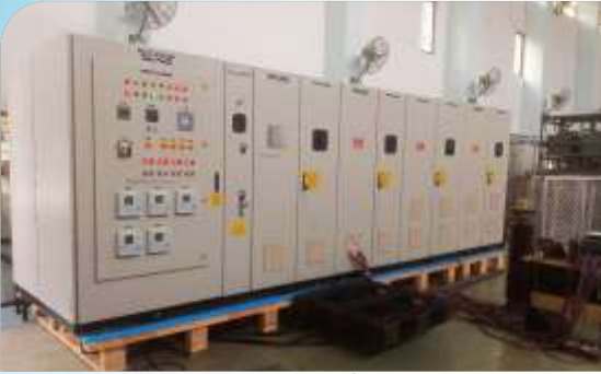
6.6 केवी, 4000 केवीएआर, 3Ø, 50 हर्ट्ज एमवी एपीएफसी पैनल के परीक्षण के लिए परीक्षण व्यवस्था
