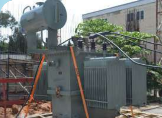
1250 केवीए, 11/0.415 केवी वितरण ट्रांसफार्मर पर गतिशील और तापीय लघु परिपथ परीक्षण
