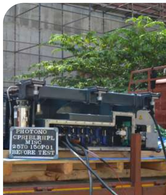
2400 केवीए, 25 केए ट्रेक्शन ट्रांसफार्मर पर डायनामिक शॉर्ट सर्किट परीक्षण और इनरश करंट मापन परीक्षण
