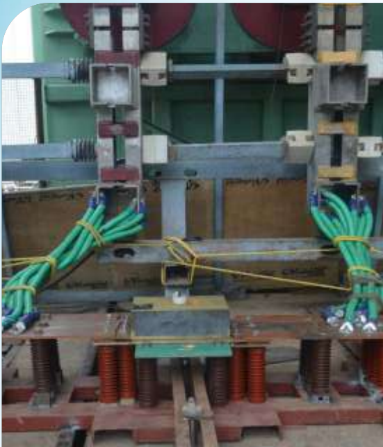
हाई करंट मेज़रिंग शंट (हाई करंट मापने वाला शंट) पर 100 केए के लिए 3 सेकंड की शॉर्ट-टाइम विदस्टैंड करंट और 250 केए पीक करंट परीक्षण
