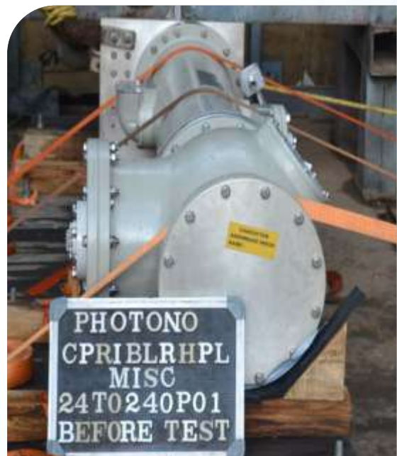
245 केवी गैस इंसुलेटेड लाइन (गैस इंसुलेटेड लाइन - जीआईएस) 50 केए आरएमएस पर, 3 सेकंड के लिए शॉर्ट-टाइम विदस्टैंड करंट परीक्षण
