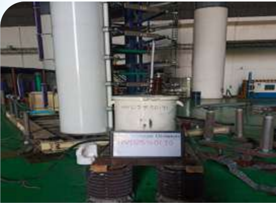
5केवीए और 25केवीए, 6.35/0.240 केवी, एकल ध्रुव वितरण ट्रांसफार्मर पर चॉपड इंपल्स वोल्टेज परीक्षण
