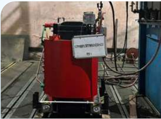
2500 केवीए, 11/0.415 केवी, तीन फेज़, कास्ट रेजिन ड्राई टाइप वितरण ट्रांसफार्मर पर नियमित परीक्षण
