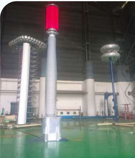
1680केवीपी पर 600 चॉपड इम्पल्स के अनुप्रयोग के साथ 765केवी धारा ट्रांसफार्मर पर मल्टी चॉपड इम्पल्स परीक्षण
