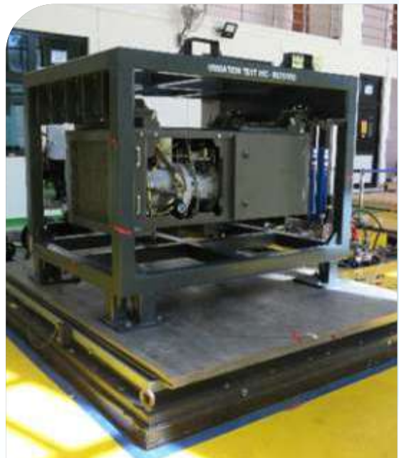
एयर जनरेशन और ट्रीटमेंट यूनिट पर कंपन और प्रघात परीक्षण
