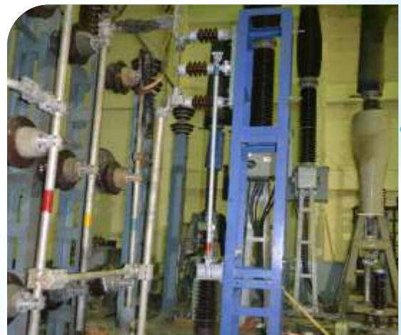
12केवी और 36केवी सिंगल पोल न्यूट्रल डिस्कनेक्टर पर लघु कालीन धारा परीक्षण
