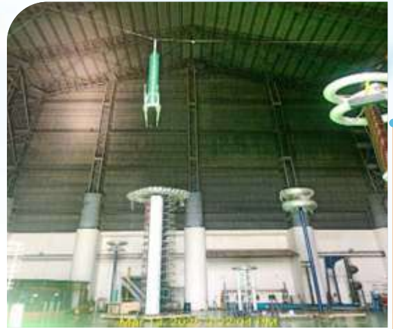
132केवी और 400केवी केबल सिस्टम के लिए उपयुक्त लिंक बॉक्स 3/1 और 6/1 पर चॉपड इंपल्स वोल्टेज परीक्षण
