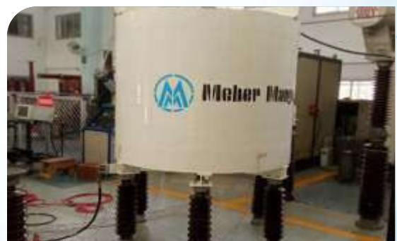
एयर कोर, ड्राय टाइप, 10, 33/ 3 केवी फ़िल्टर रिएक्टर पर तापमान वृद्धि परीक्षण
