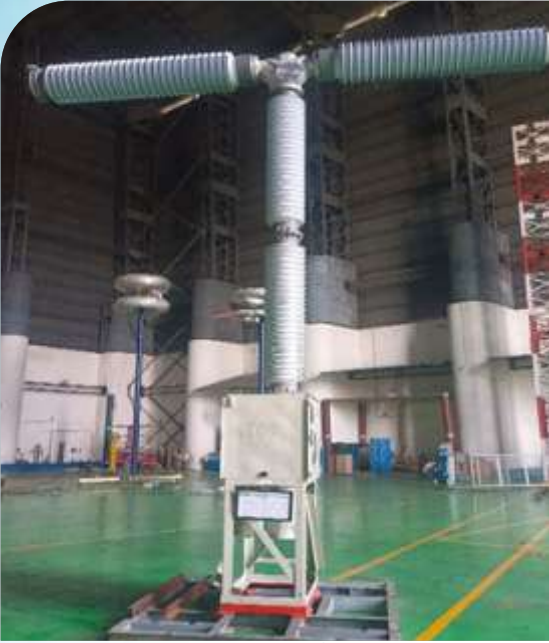
दो स्रोतों का उपयोग करके 420केवी एसएफ6 गैस सर्किट ब्रेकर पर लाइटनिंग इम्पल्स और स्विचिंग इम्पल्स परीक्षण (संयुक्त वोल्तेज परीक्षण)
