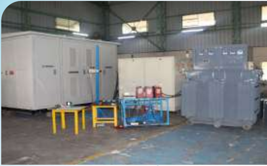
2 एमवीए, 11 केवी/433 वी ड्राय टाइप ट्रांसफार्मर वाले कॉम्पैक्ट उपकेन्द्र पर सतत धारा परीक्षण
